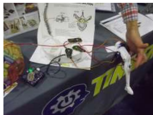
教材の例：足の神経信号の伝わり方を LED を含む電気回路で見せている。
